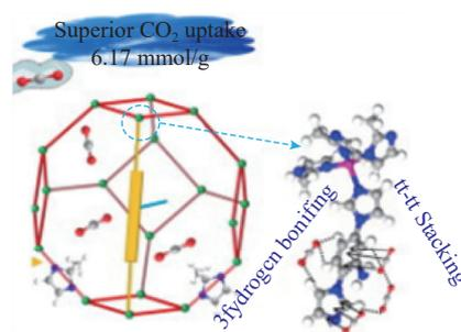
(c) CO<sub>2</sub> 在孔结构中的吸附作用位点
