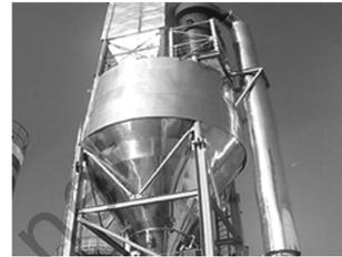
图2 20 t/h NGD 脱硫除尘一体化装置
